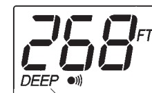
Alarme de perte de fond
