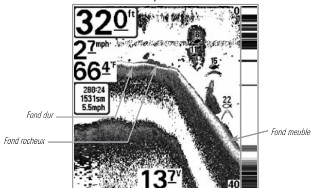
Profil de fond avec fenêtre sonar en temps réel [RTS]. Accessoire Tempér./Vitesse facultatif.
