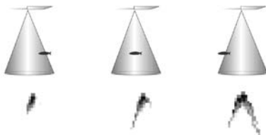
Faisceau du transducteur et arcs de poisson
